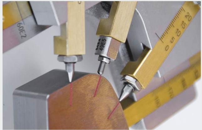
SKM 2: Messung des Fahrkantenverschleißes an drei Punkten
